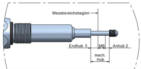
Bitte beachten Sie, dass der angegebene Anhub und Endhub (siehe Ausschnitt) Richtwerte sind. Bei Kalibrierung des Sensors vor Auslieferung wird auf bestmögliche Linearität geachtet.
