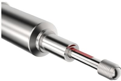
Die Option VH sollte gewählt werden, wenn der Sensor in Flüssigkeiten (Öl, Wasser, ...) betrieben wird oder mit schnellen Druckschwankungen zu rechnen ist. Durch die Planflächen (siehe Bild: rot markierte Flächen) auf den Mechanikteilen des Sensors wird der Druckausgleich bzw. die „Belüftung“ innerhalb des Sensors erleichtert.
